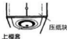
5) 检查压纸块下方的上模头(如上图右)上是否粘附有纸屑，用随机提供的镊子除去(注意动作要轻柔，以免损坏模头保护层)。
