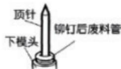
4) 剩余的管子被顶针顶出后，顶针下缩，用随机提供的镊子夹住管子，使管子相对顶针运动而从顶针上除去(如下图)。
