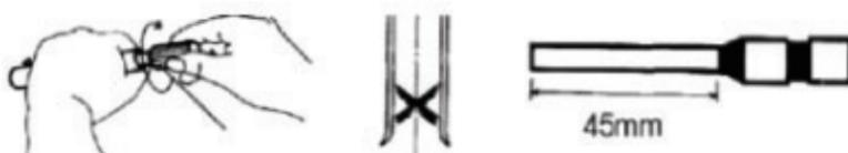
【注意：钻头的磨刃极限为45毫米。小于这个数值，建议报废（如上图右）。】
