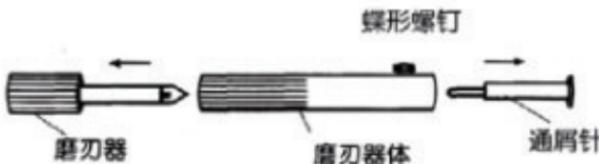
2) 将钻头插入磨刃器体内，使刀柄端面与磨刃器体端面对齐，用蝶形螺钉固定（下图左）；
