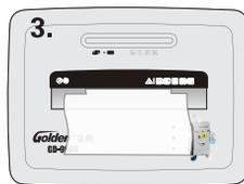
3. 当你想中止正在粉碎的纸张时,拨动按钮至“手动”档,机器将会立即反转将待碎纸张退出。
