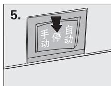
5. 工作完毕,拨动按钮至“停止”档,切断电源。
